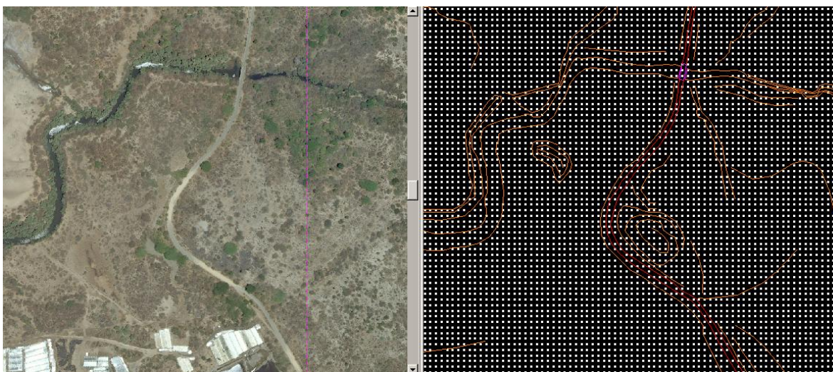
Fig.4 Extracción de la Matriz Vectorial de Datos de Elevación desde la aerofotografía.
